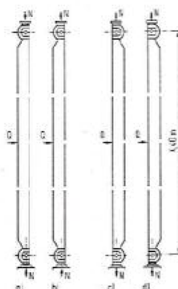
Bild 8. Versuche zur Überprüfung der Grenztragfähigkeiten an RHP-Stäben 150 \times 100 \times 8 mit Bolzen M27/10.9 a und d sind gelenkig, b und c eingespannt gelagert Fig. 8. Tests for determining the capacities of RHP members 150 \times 100 \times 8 with bolts M27/10.9 a and d are pinned, b and c are rigidly fixed
